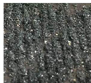
図 3 マグネットシートに砂鉄をまくと筋が見える
