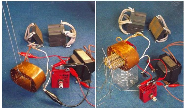
③持ち手を付けたトランス鉄心 E 型部にコイルをはめ、直流電流を通すと、鉄材も持ち上げることができる。
