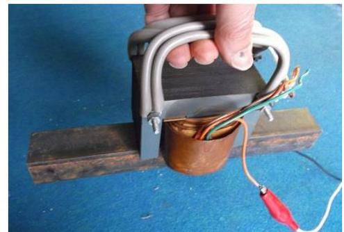
④トランス鉄心 E 型部を板に固定し、持ち手を付けた I 型鉄心部を合わせると、離すことができないほど強くなる。
