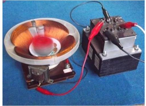
②コイルの上部に茶碗や皿を置き、その上に半球状の容器に入れたスチールウールやNSが左右になっている磁石に軸を付けたコマを置く。
