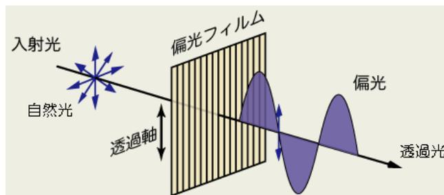
自然光を1枚の偏光板に通して見るとき、偏光板を回転させても透過光の明るさは変わらない。しかし、偏光板を2枚重ねて一方だけを回転させると、その角度によって明るさが変化する。これは、光が横波であることを示している。
